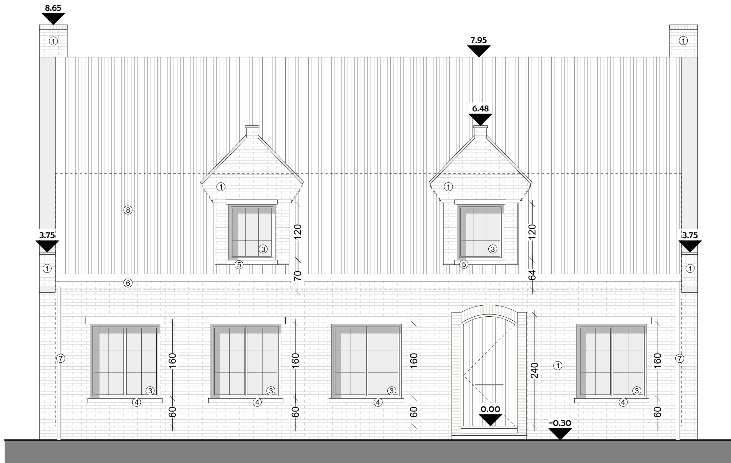
VOORGEVEL bestaande toestand
