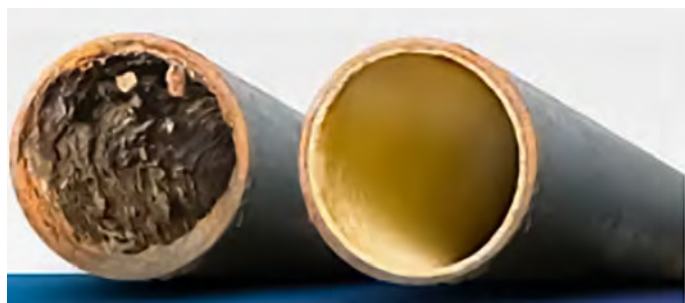
Principe: aangetaste buis voor en na renovatie
